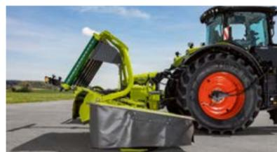
Quando i tappeti non servono, possono essere girati in avanti sopra le unità falcianti con conseguente spostamento del baricentro vicino a trattore.
