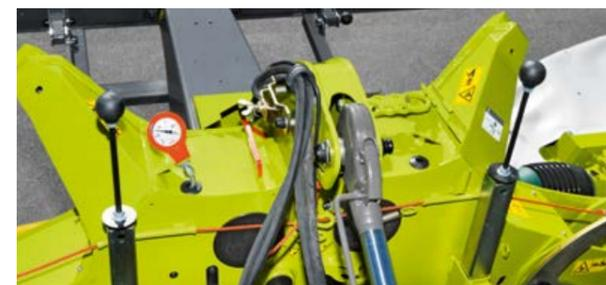
Un manometro per regolare con facilità la pressione d'appoggio di entrambe le unità falcianti.
