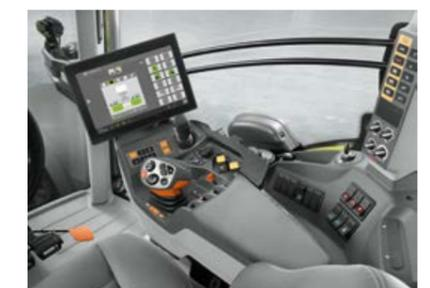
Se il trattore è dotato di un terminale compatibile ISOBUS, il comando di preselezione per la CONTOUR può essere eseguito direttamente tramite questo terminale.
