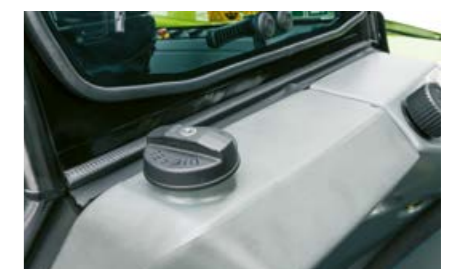
Serbatoio carburante chiudibile a chiave dietro la cabina.
