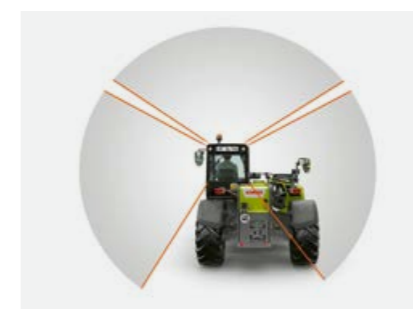
Visuale posteriore priva di ostacoli grazie al braccio telescopico ribassato, per una maggiore sicurezza operativa.
