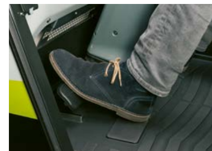
Il pedale del freno con funzione di marcia lenta riduce il consumo di carburante e l'usura dei freni.
