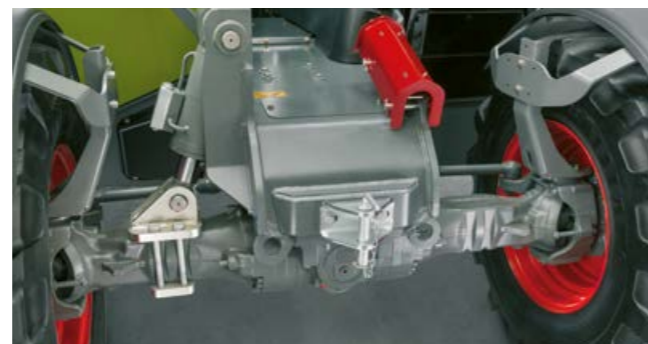
Maggiore sicurezza in campo con la compensazione del livello idraulica.
