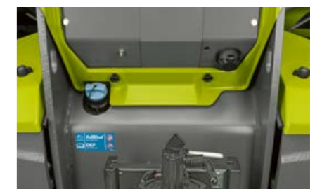
Facile accesso al bocchettone del serbatoio AdBlue® per un trattamento efficace dei gas di scarico.
